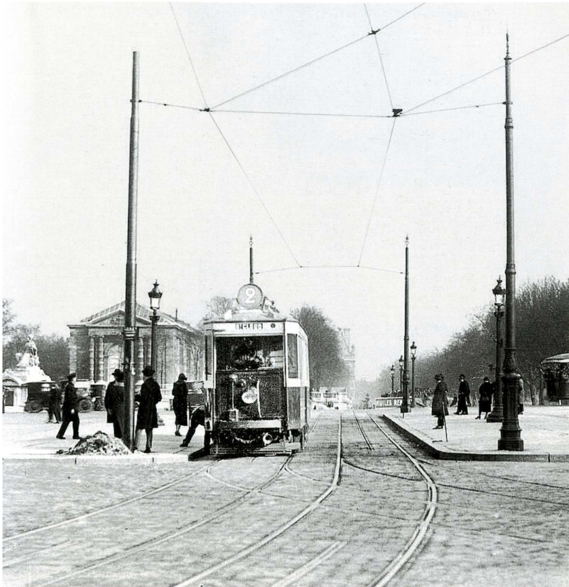
Les tramways dans Paris (ici place de la Concorde) avec leur prise de courant par caniveau central ou par fil trolley
